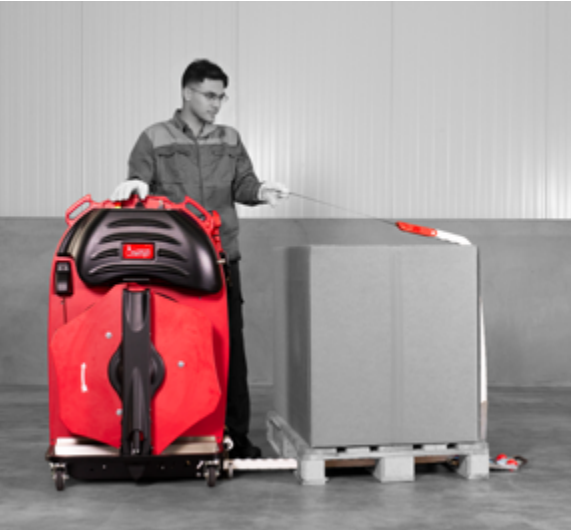
Sube por la parte trasera y lleva el fleje directamente a la mano del trabajador. La cadena se retira.
